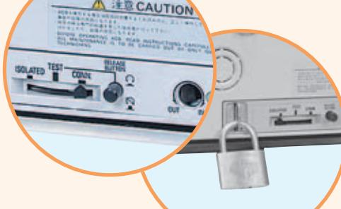
→ Korišćenjem zaključavanja pozicije može se sprečiti nanamerno pomeranje tela prekidača. Telo prekidača se može zaključati u položajima: POVEZAN, TEST i IZOLOVAN. Moguće je postaviti do tri katanca.
